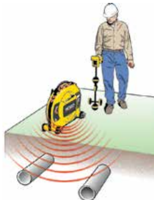
Kablo hatlarının yerini saptamak için sinyal oluşturulması
