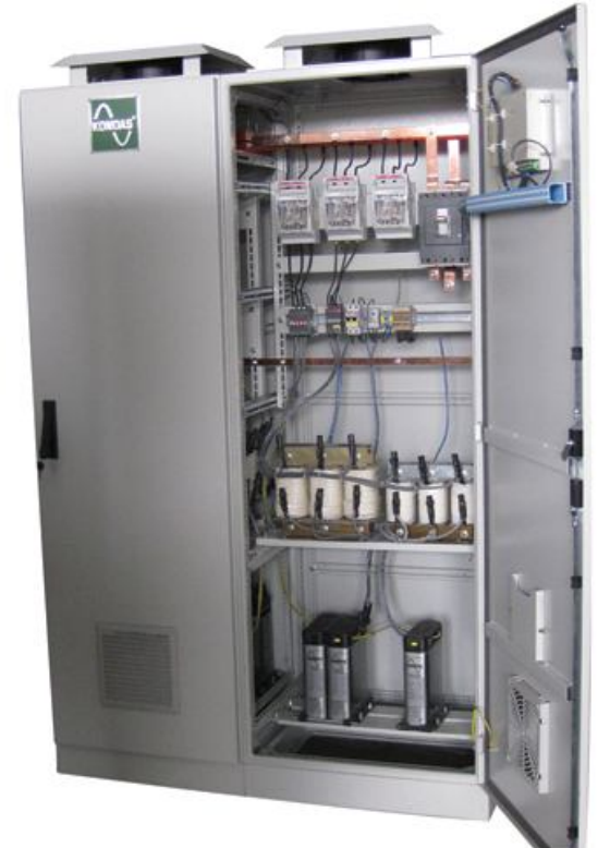
530 V %14 H.F Reaktörlü 160 kVar İndüksiyon ocak kompanzasyon sistemi
